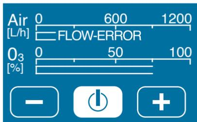
La quantità d'aria è inferiore a 250 L/h. L'apparecchio si spegne per proteggersi dal surriscaldamento. Verificare l'afflusso di aria, eventualmente eliminare le occlusioni.
