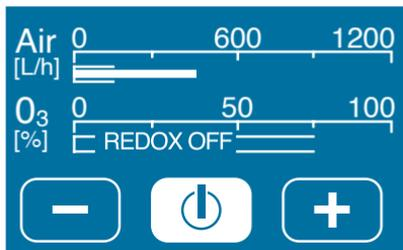
Se viene raggiunto il valore nominale redox impostato sul misuratore redox, la generazione di ozono viene disattivata; se il valore redox impostato non viene raggiunto, la generazione di ozono viene attivata.
