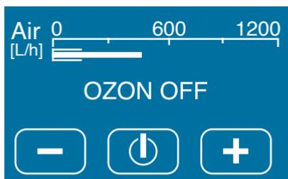
L'indicatore a barra in alto («Air») indica la portata dell'aria attraverso l'apparecchio (in L/h).
