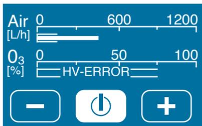
Danni all'elemento per l'ozono (ad esempio penetrazione di acqua o di particelle contaminanti). Spegner il generatore di ozono e disinserire la spina di alimentazione. Pulizia dell'elemento per l'ozono. Soffiare aria all'interno per eliminare l'acqua penetrata. Se l'anomalia permane, l'ozonizzatore deve essere spedito per una verifica.
