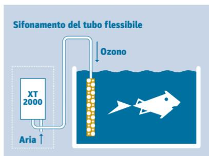
L'ozonizzatore può anche essere montato senz'altro in un armadio tecnico. In questo caso occorre provvedere a una buona aerazione per evitare il surriscaldamento dell'apparecchio. Se l'ozonizzatore viene installato in un armadio, deve essere previsto un sifonamento del tubo flessibile verso l'alto, al fine di evitare il reflusso dell'acqua.
