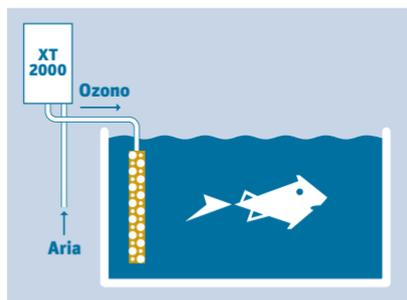
Sul retro dell'ozonizzatore sono presenti due passanti per fissaggio. Consentono di fissare l'ozonizzatore alla parete. Se possibile l'apparecchio deve essere applicato al di sopra del livello dell'acqua. In tal modo, se ad esempio viene a mancare l'energia elettrica, l'acqua non può refluire nell'apparecchio.
