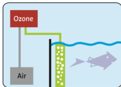
Il CERTIZON è dotato di un regolatore (potenziometro) (1). Con esso è possibile impostare in continuo la portata di ozono. A titolo di valore orientativo si consideri, per 100 l di acqua di mare, ca. 10 mg di ozono/ora e per 100 l di acqua dolce ca. 5 mg di ozono/ora.
